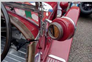
Une pièce, deux usages: d'un côté un rétroviseur et de l'autre un projecteur, le tout orientable. Sur les phares, des demi-sphères favorisant l'aérodynamisme.
